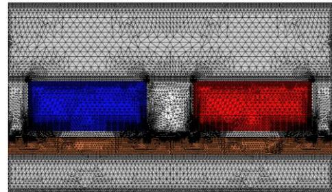
Figure 5. Meshing of TORUS-NS machine.
